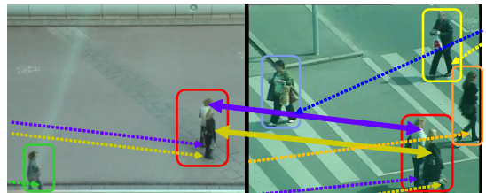
図1 監視カメラの映像例。広域人追跡の実現には、各カメラの視野内で撮影された人の追跡(破線)と、各カメラで撮影された人の中で同一人物判定を行うカメラ間人同定(実線)が必要。各枠はそれぞれグループを示している。
