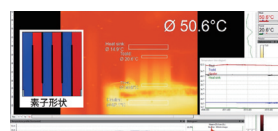
80 ^{\circ} Cで作製可能な一体型(チップ型)熱電発電素子の作製プロセスと温度評価の様子
