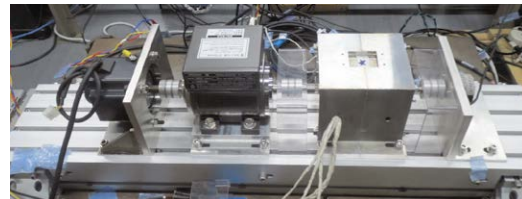
コア損を計測するモータシミュレータ
