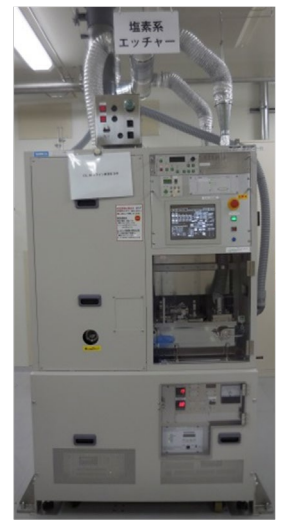
ドライエッチング装置
