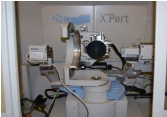
結晶性解析X線回折装置
