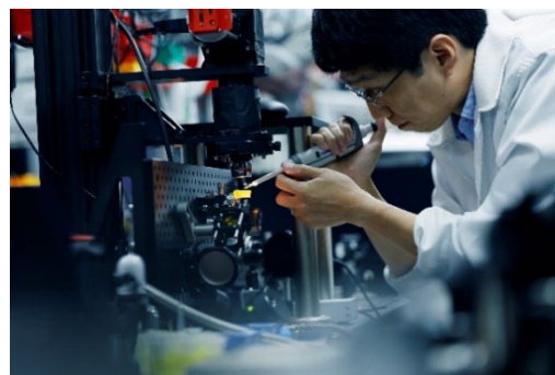
中赤外レーザーATR正立顕微鏡で光操作の実験準備を行っている様子(工藤講師)。
