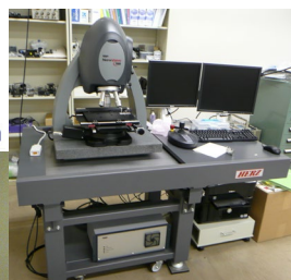
動的計測対応の白色干渉計
